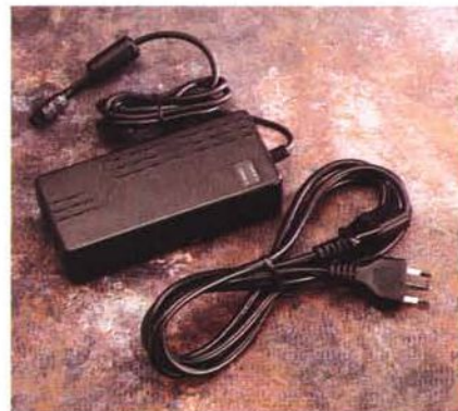
L'alimentatore dello Hyundai HN-5000 presenta la particolarità della doppia uscita: 19 V per il computer e 12/19 V per ricaricare le batterie.
